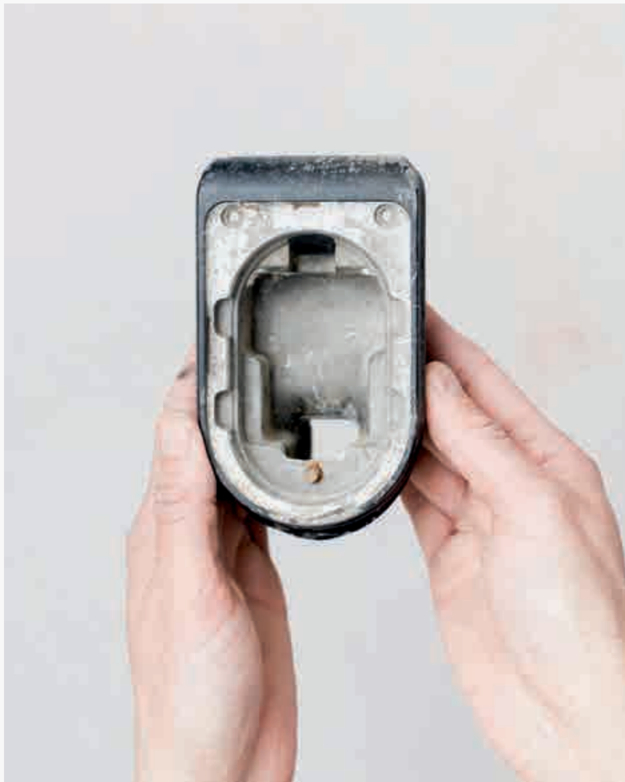
Image 9. Réceptacle du boîtier d'affichage du guidon.
