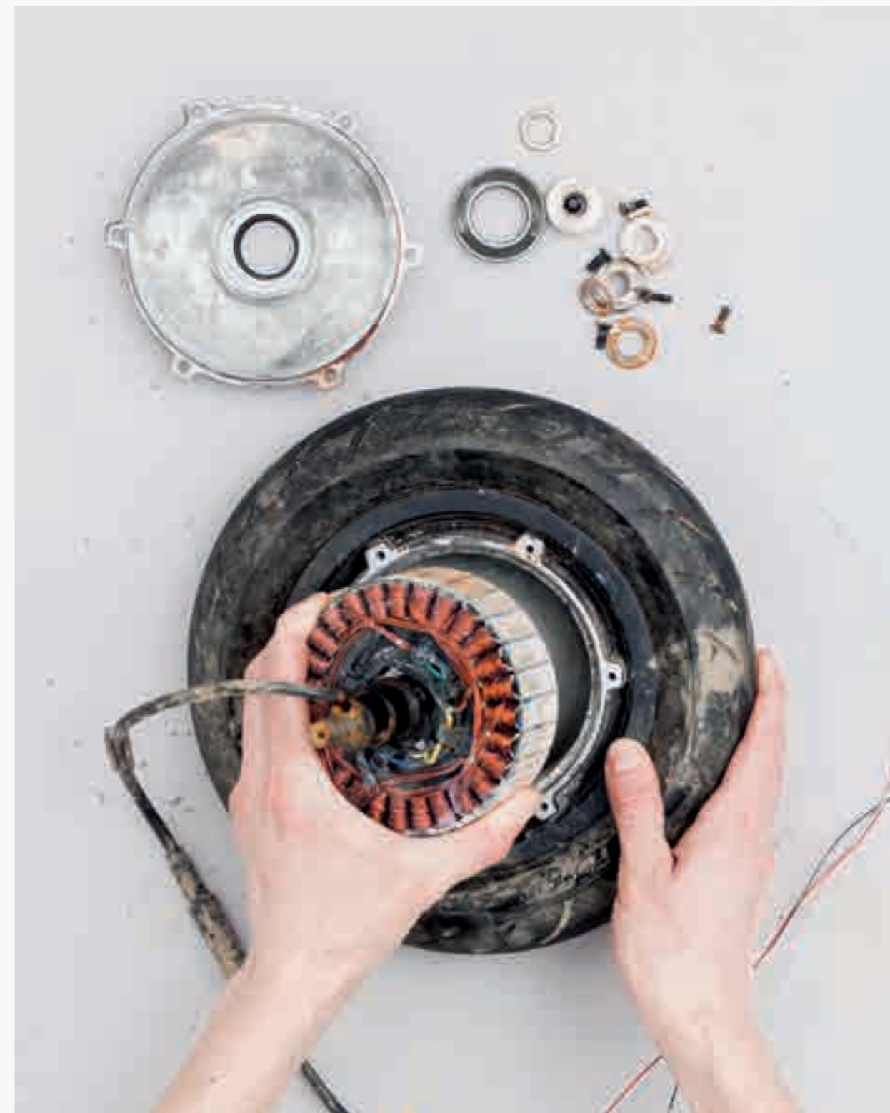
Image 5. Extraction du moteur électrique de la roue arrière.
